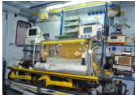
Fig. 4. Interior de l'ambulància amb equipament previst per al trasllat neonatal (configuració 2006-2015).
